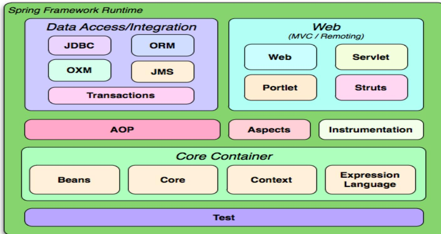
Spring 框架是一个分层架构,它包含一系列的功能要素并被分为大约20个模块。这些模块分为Core Container、Data Access/Integration、Web、AOP ( Aspect Oriented Programming)、Instrumentation和测试部分,如图所示。
